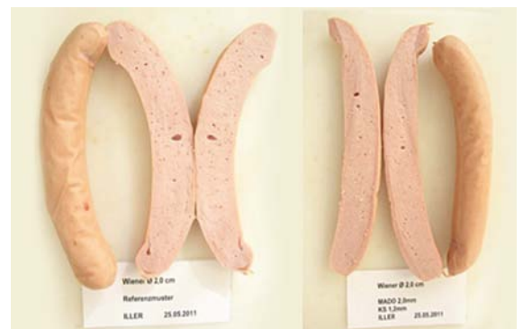
Vergleich: Herkömmlich produzierte Würstchen (li.) und mit dem MADO-Extruderwolf hergestellte Würstchen.
